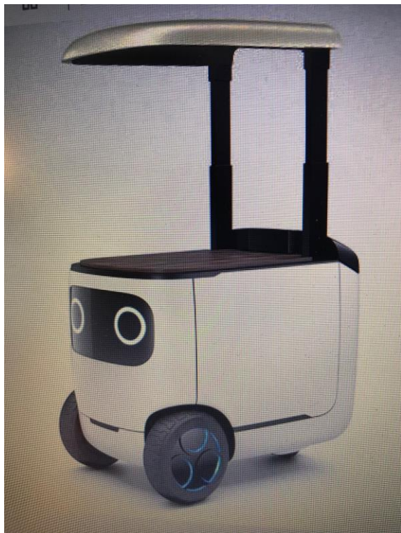
Figur 13.1 Hondas konceptfordon för leverans av mindre godsmängder
