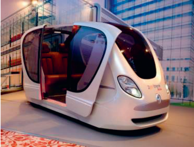
Bild 14 2gettheres minibuss som använder magneter för att navigera.
