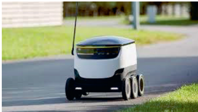
Bild 21 Robot för varuleverans utvecklad av Starship Technologies.
