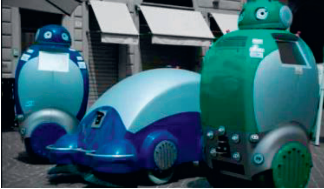
Bild 26 Robotar för gatuhållning och sophantering som utvecklats inom DustBot.
