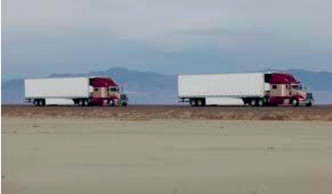
Bild 16 Pelotons eftermarknadslösning för kolonnkörning med två lastbilar.
