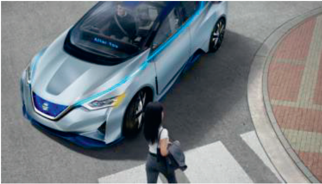
Bild 2 Nissans gränssnitt för kommunikation med fotgängare.
