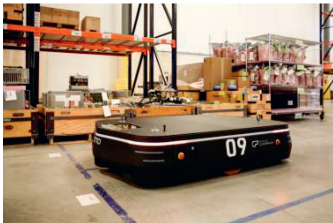
Bild 24 Roboten Otto från Clerpath Robotics som förflyttar varor i fabriker.
