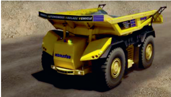
Bild 29 Komatsus helt självkörande lastbil för användning i gruvor.
