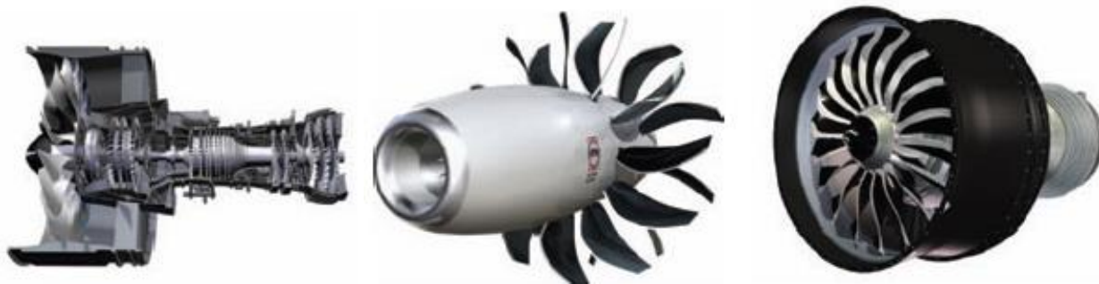
Figur 17 Jetmotor med växlad fläkt, utanpåliggande fläktar och "advanced" utformning
