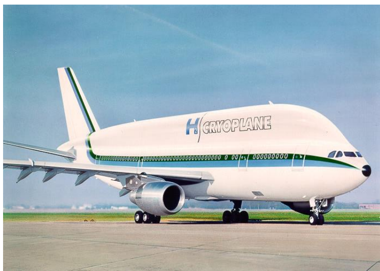
Figur 15 Vätgas som bränsle får dramatiska effekter på aerodynamiken
